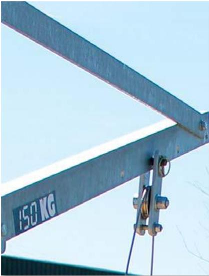
Polea independiente con rodamiento de rodillos
